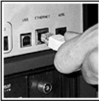
1. Connectez l'un des connecteurs RJ45 du câble Ethernet dans la prise marquée "Ethernet" de votre Freebox.
