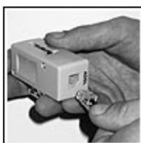
1. Connectez l'une des prises RJ11 du cordon téléphonique au filtre, dans la prise marquée "ADSL"
